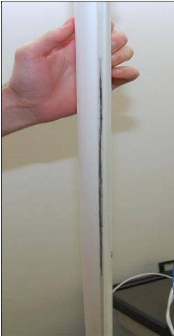
Figure 5 Edge Crack
