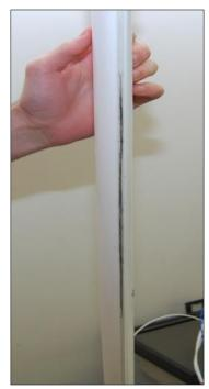
Figure 5 Edge Crack
